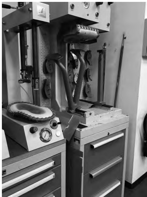
フランクフルト市立劇場の靴製作室 (靴底プレス機)
