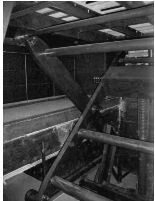
クロスレバー (シザー) 方式迫り機構
